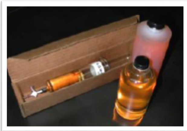
איור 31: מימין: דיגום בתנאים קשים: לחות גבוהה, מתאם מיוחד לברז השנאי, וגישה לא נוחה. משמאל: ערכת דיגום
