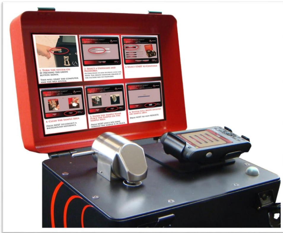
איור 14: ספקטרוטומטר FTIR למדידת ריכוזי חומרים באמצעות ניתוח בליעת אור
