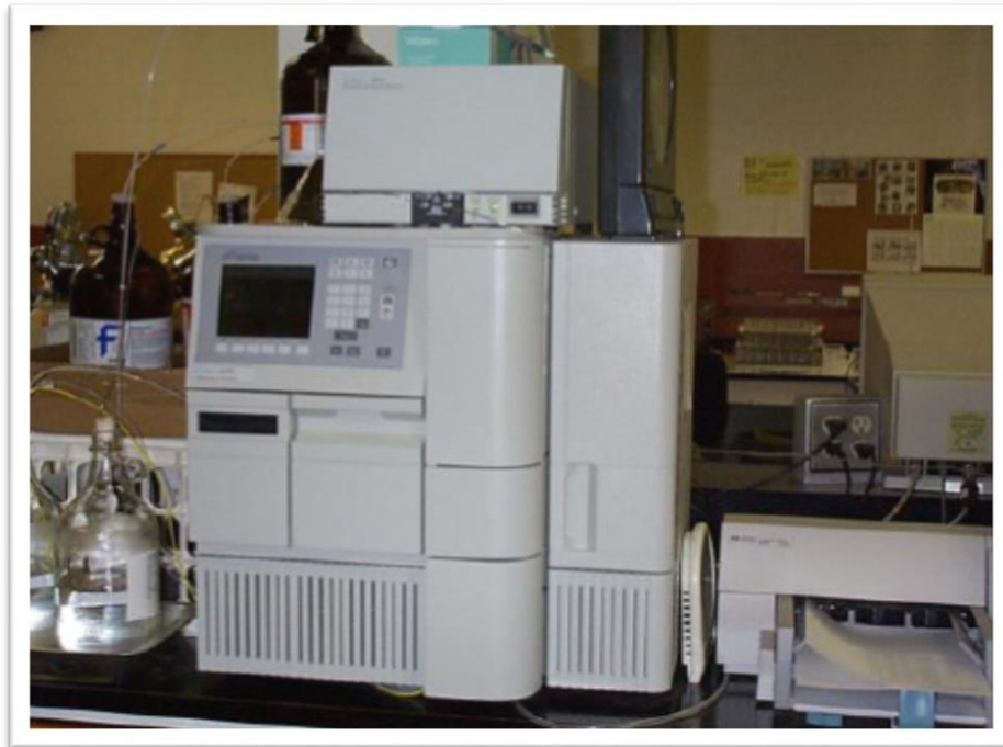
איור 27: מערכת HPLC לבדיקת פוראנים ב PPB
