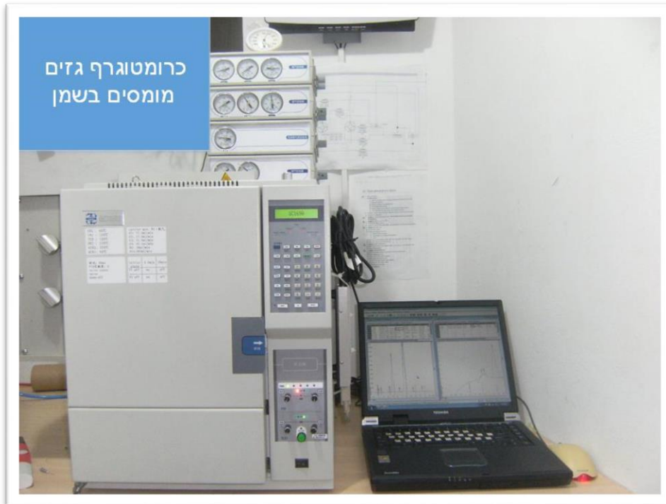
איור 25: ציוד כרומטוגרפיה ממוחשבת לבדיקת גזים מומסים
