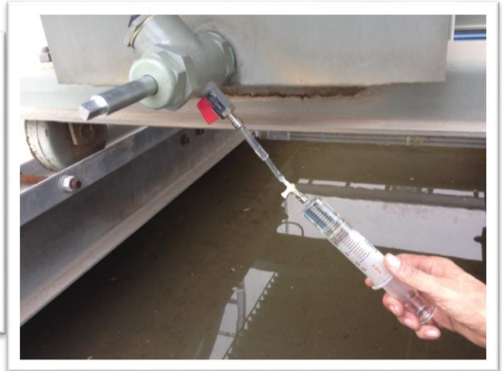
איור 31: מימין: דיגום בתנאים קשים: לחות גבוהה, מתאם מיוחד לברז השנאי, וגישה לא נוחה. משמאל: ערכת דיגום
